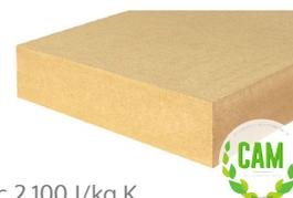
Pannello in fibra di legno densità 140 kg/m<sup>3</sup> | Conducibilità termica dichiarata  $\lambda_D$ [W/(m\*k)] 0,041 | Calore specifico c 2.100 J/kg K
