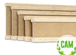
Pannello in fibra di legno densità 265 kg/m<sup>3</sup> | Conduttività termica dichiarata  $\lambda_p$  [W/(m\*k)] 0,048 | Calore specifico c 2.100 J/kg K
