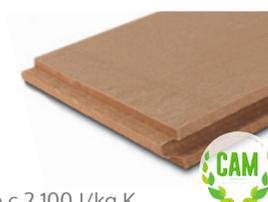
Pannello in fibra di legno densità 270 kg/m<sup>3</sup> | Conduttività termica dichiarata  $\lambda_p$ [W/(m\*k)] 0,048 | Calore specifico c 2.100 J/kg K
