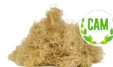
Fibra di canapa isolante con densità a seconda della densità del riempimento e della profondità della cavità | Calore specifico c 1700 J/kg K
