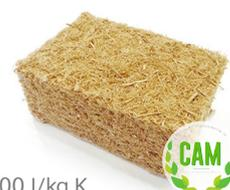
Pannello in fibra di legno densità 60 kg/m<sup>3</sup> | Conduttività termica dichiarata  $\lambda_D$ [W/(m\*k)] 0,036 | Calore specifico c 2.100 J/kg K
