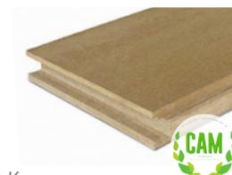
Fibra di legno densità  $240 \text{ kg/m}^3$  | Conduttività termica dichiarata  $\lambda_p [\text{W}/(\text{m}^*\text{k})]$  0,046 | Calore specifico  $c$  2.100 J/kg K
