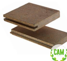
Pannello in cementolegno densità 1350 kg/m<sup>3</sup> | Conduttività termica dichiarata  $\lambda_D$ [W/(m\*k)] 0,26 | Calore specifico c 1.880 J/kg K
