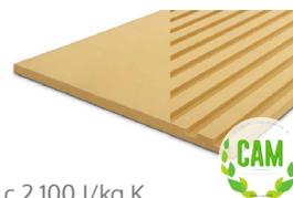
Pannello in fibra di legno densità 140 kg/m<sup>3</sup> | Conducibilità termica dichiarata  $\lambda_D$ [W/(m\*k)] 0,040 | Calore specifico c 2.100 J/kg K
