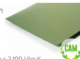
Pannello in fibra di legno densità  $250 \text{ kg/m}^3$  | Conduttività termica dichiarata  $\lambda_p [\text{W}/(\text{m}^*\text{k})]$  0,070 | Calore specifico  $c$  2.100 J/kg K
