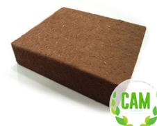
Pannello in fibra di legno densità 140 kg/m<sup>3</sup> | Conduttività termica dichiarata  $\lambda_D$ [W/(m\*k)] 0,040 | Calore specifico c 2.100 J/kg K
