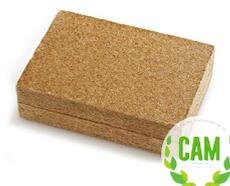
Pannello in fibra di legno densità 160 kg/m<sup>3</sup> | Conduttività termica dichiarata  $\lambda_D$  [W/(m\*k)] 0,039 | Calore specifico c 2.100 J/kg K
