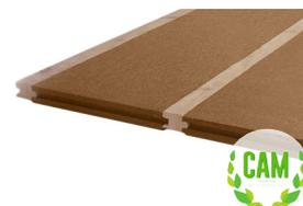
Pannello in fibra di legno densità 160 kg/m<sup>3</sup> | Conduttività termica dichiarata  $\lambda_D$ [W/(m\*k)] 0,038 | Calore specifico c 2.100 J/kg K
