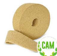
Pannello in fibra di legno densità 60 kg/m<sup>3</sup> | Conducibilità termica dichiarata  $\lambda_D$ [W/(m\*k)] 0,038 | Calore specifico c 2.100 J/kg K
