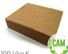
Pannello in fibra di legno densità  $250 \text{ kg/m}^3$  | Conduttività termica dichiarata  $\lambda_p [\text{W}/(\text{m}^*\text{k})]$  0,048 | Calore specifico  $c$  2.100 J/kg K
