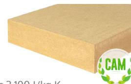
Pannello in fibra di legno densità 110 kg/m<sup>3</sup> | Conduttività termica dichiarata  $\lambda_D$  [W/(m\*k)] 0,037 | Calore specifico c 2.100 J/kg K
