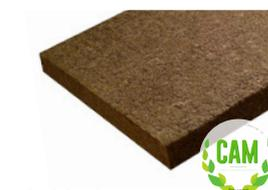
Pannello in fibra di legno densità 280 kg/m<sup>3</sup> | Conduttività termica dichiarata  $\lambda_p$ [W/(m\*k)] 0,050 | Calore specifico c 2.100 J/kg K
