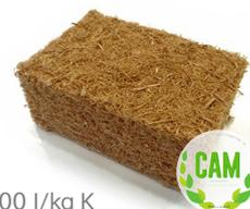
Pannello in fibra di legno densità 50 kg/m<sup>3</sup> | Conduttività termica dichiarata  $\lambda_D$ [W/(m\*k)] 0,038 | Calore specifico c 2.100 J/kg K
