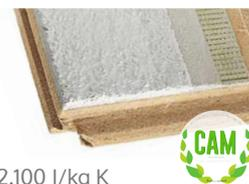
Pannello in fibra di legno densità 180 kg/m<sup>3</sup> | Conduttività termica dichiarata  $\lambda_D$  [W/(m\*k)] 0,043 | Calore specifico c 2.100 J/kg K
