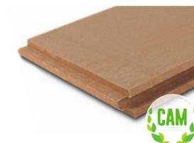
Fibra di legno spessori da 52 a 100 mm densità 180 kg/m<sup>3</sup> | Conduttività termica dichiarata  $\lambda_p$ [W/(m\*k)] 0,043
