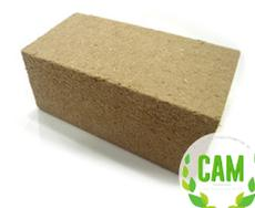
Pannello in fibra di legno densità 230 kg/m<sup>3</sup> | Conduttività termica dichiarata  $\lambda_p$ [W/(m\*k)] 0,050 | Calore specifico c 2.100 J/kg K
